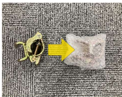
1.単管用取付金具を緩衝材で保護
